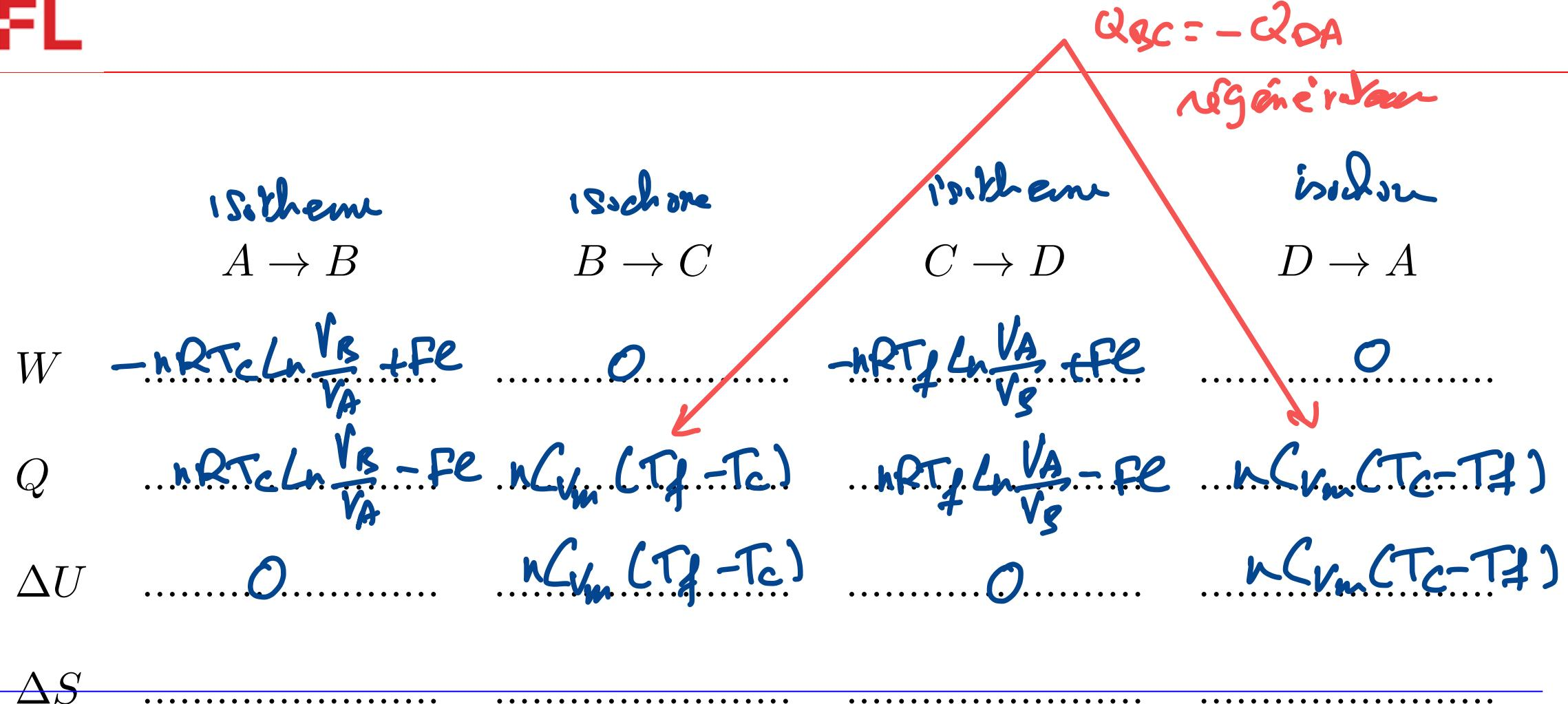
7. Quelle est la condition sur  $F$  pour que le moteur fonctionne ? Que se passe-t-il sinon ?
